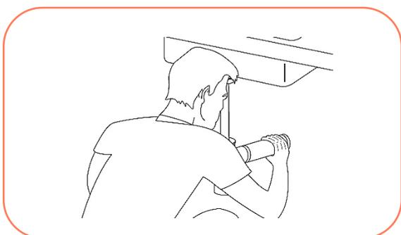
7° Verifique se há vazamento no sistema abrindo a torneira. Em caso positivo, remonte-o apertando todos os componentes;
