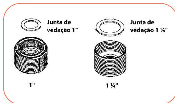
2° Para fazer a ligação: Em válvulas para pias e lavatórios (1" (7/8)) e tanques (1.¼), instale o adaptador roscável na válvula e, depois, rosqueie a sobreporca no adaptador roscável. Em válvulas para pia americana (1.½), rosqueie a sobreporca diretamente na válvula;
