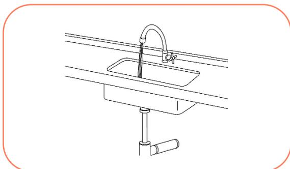
8° Finalize limpando o sifão, a válvula da pia e a ligação na parede.
