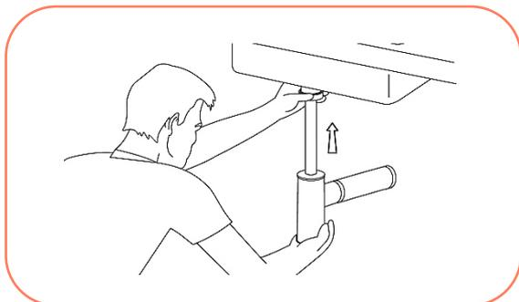
6° Encaixe o tubo de saída na saída de esgoto. Ajuste o sistema para que fique no nível e no prumo. Aperte todos os componentes;
