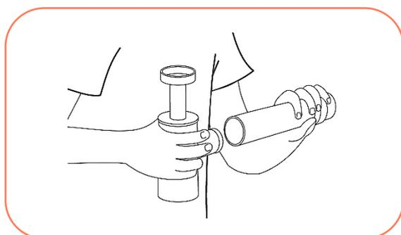
2° Monte o sifão deixando as peças frouxas para que o ajuste seja feito ao final da instalação. Rosqueie provisoriamente o Sifão na válvula de escoamento da pia;
