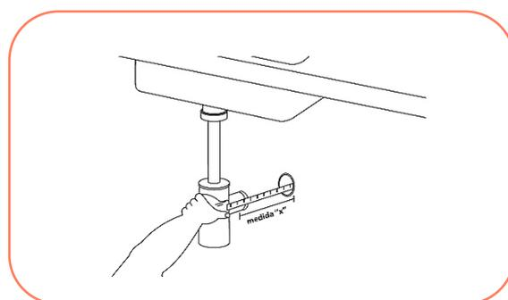
4° Se necessário, corte o tubo de saída deixando-o na medida exata;
