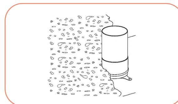
4° Aguarde a cura do concreto, desforme a parte inferior da laje e finalize a instalação do sistema de esgoto.
