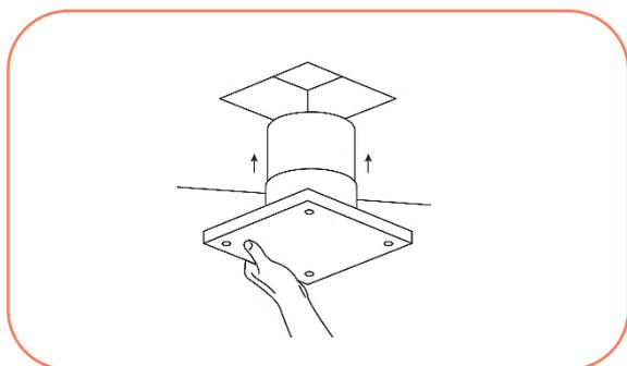
2° Acople um segmento de tubo na luva com fixadores, fazendo a soldagem padrão PVC, lixar a bolsa e ponta do tubo, fazer a limpeza com a solução preparadora e aplicar Adesivo PVC na bolsa e na ponta do tubo;
