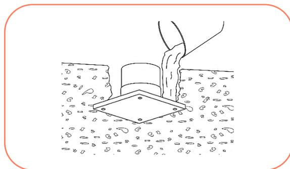
4° Após a cura do concreto, retire a placa de madeira e finalize a instalação do sistema de esgoto.
