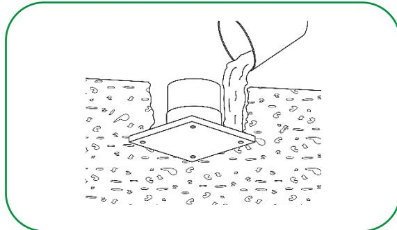
4º Após a cura do concreto, retire a placa de madeira e finalize a instalação do sistema de esgoto.
