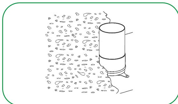
4º Aguarde a cura do concreto, desforme a parte inferior da laje e finalize a instalação do sistema de esgoto.
