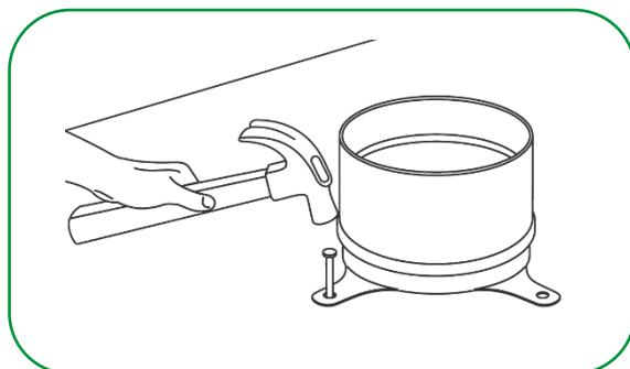
2º Acople um segmento de tubo na luva com fixadores, fazendo a soldagem padrão PVC, lixar a bolsa e ponta do tubo, fazer a limpeza com a solução preparadora e aplicar Adesivo PVC na bolsa e na ponta do tubo;
