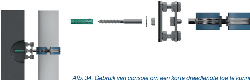
Afb. 34. Gebruik van console om een korte draadlengte toe te kunnen passen.
