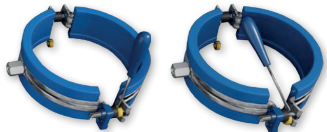
Afb. 30. Vaste beugel maken uit een glijbeugel: verwijder de open afstandsringen.
