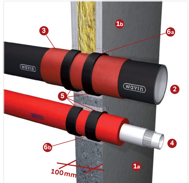
Gerade Rohrführung durch Wand.
