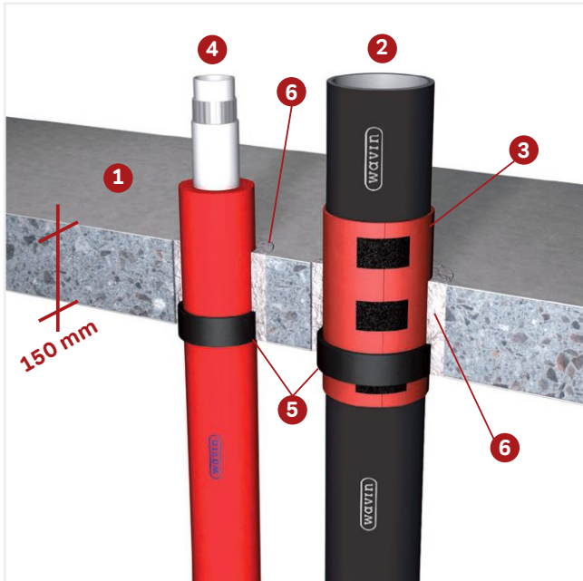
Gerade Rohrführung durch Decke.
