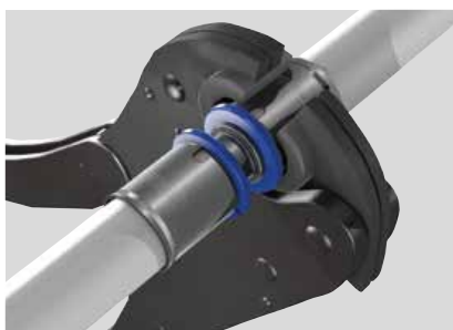
Fig. 21: Placering av pressbacken på Tigris K1-beslaget.
