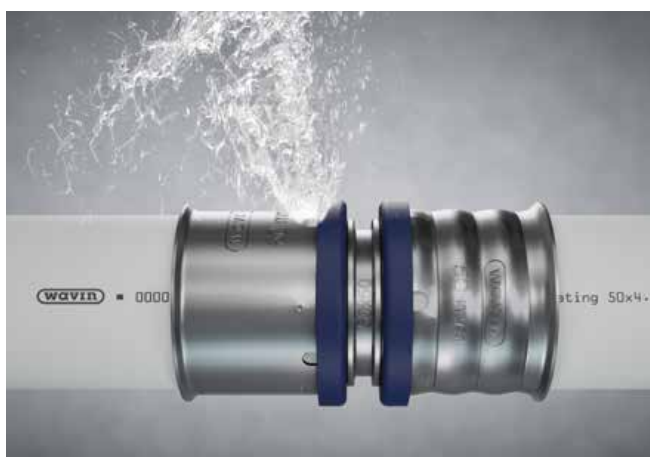
Fig. 14: GARANTERAT LÄCKAGE vid tryckprovning visar vilken koppling som inte har pressats genom att den läcker vatten.
