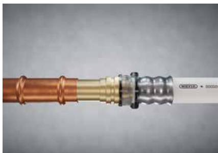
Fig. 23: Övergångskoppling för metall- och kopparrör med Tigris K5 och Tigris M5.
