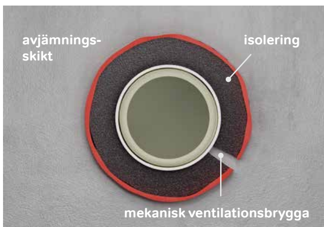
Fig. 33: Mekanisk vibrationsöverföring genom defekt rörisolering.
