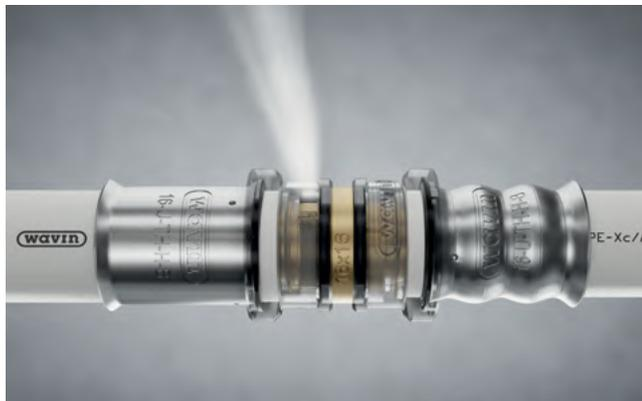
Wavin Tigris M5 est le premier et le seul raccord à être équipé d'ACOUSTIC LEAK ALERT, un système de détection acoustique des fuites simple et intégré pour les pré-réceptions à l'air. Cette fonctionnalité permet aux installateurs de repérer les fuites causées par des raccords non sertis : avec ACOUSTIC LEAK ALERT, tout raccord non sertis émet un sifflement (80dB), ce qui rend plus facile la localisation de la source de la fuite.
