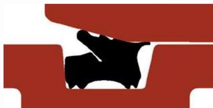
La structure à quatre niveaux réduit de manière significative les forces d'insertion.
