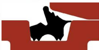
En raison de sa forme particulière, le joint d'étanchéité est fermement positionné dans la gorge. La première lèvre agit ici comme une lèvre d'appui.
