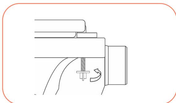
7° - Encaixe as tampas de acabamento sobre as bases, encaixe a tampa do assento novamente e observe o alinhamento entre o assento e a louça. Ajuste caso necessário.
