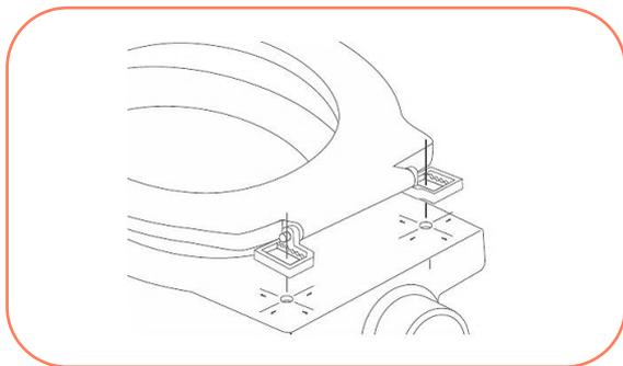
4° - Coloque os suportes ajustáveis e os parafusos;
