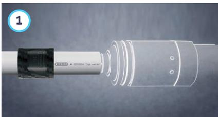
Erste Aufweitung: Weiten Sie das Rohr beim ersten Mal auf. Stellen Sie sicher, dass Sie den Aufweitungsvorgang abschliessen.
