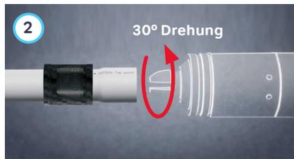
Zweite Aufweitung: Nach einer 30-Grad-Drehung des Rohres/des Werkzeugs wird mit der die zweite Aufweitung begonnen. Stellen Sie sicher, dass der Aufweitungsvorgang bis zum Erreichen des Endzyklus fortgeführt wird, um eine vollständige Aufweitung des Rohres zu gewährleisten.
