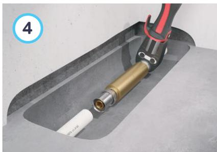
4 Montierte Verbindung verpressen.
