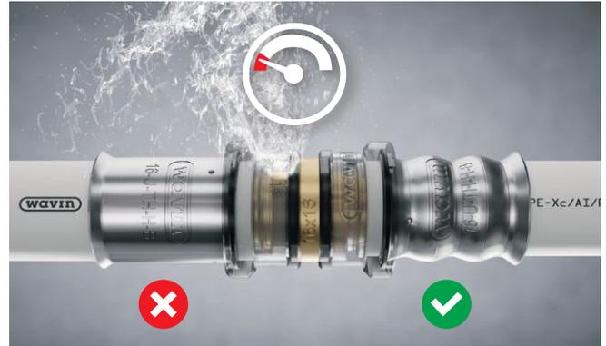
Soll-Leckage-Druckprüfung zeigt mit auslaufendem Wasser den unverpressten Fitting an
