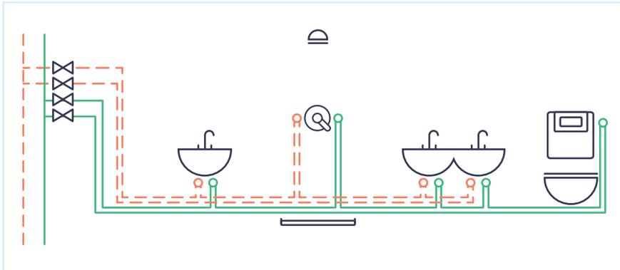
Die hier dargestellte Schleifen-/Ringleitungsinstallation eignet sich für Stockwerksinstallationen mit vorgeschalteten Wasserzählern. Dabei wird die Rohrleitung mittels Doppelanschlüssen von einer Entnahmestelle unmittelbar zur nächsten geführt. Vom letzten Verbraucher führt die Leitung dann wieder zurück zum Stockwerksanschlusspunkt.
