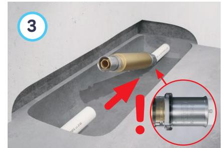
3 Sicherstellen, dass die Rohroberfläche völlig glatt und sauber ist. Einen Anschluss der Reparaturkupplung auf eines der freien Rohrenden setzen. Im Sichtfenster korrektes Einschieben des Rohrs prüfen.
