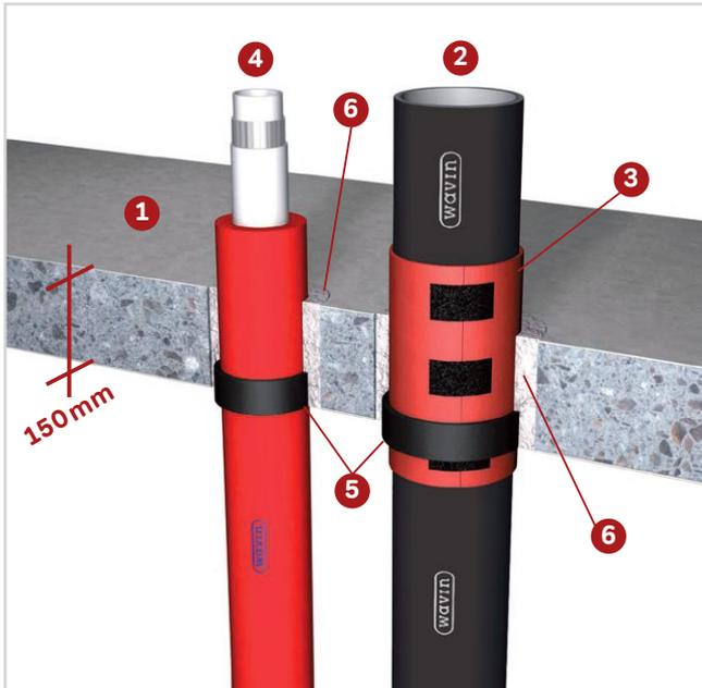
Gerade Rohrführung durch Decke
