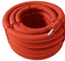
3. Wavin Mehrschicht-Verbundrohr ist im Ringbund mit **26 mm** Dämmung (Wärmeleitfähigkeit = 0,040 W/m·K) lieferbar. Dieses System entspricht der erforderlichen Dämmstoffstärke für Leitungen bis 25 mm.
