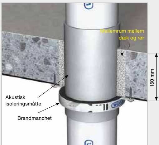
Lige gennemføring med eller uden muffe.
