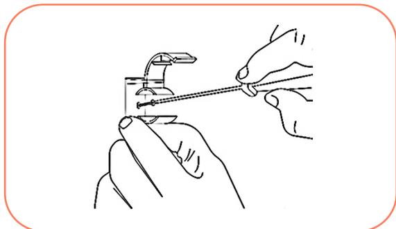
3° Inicie a montagem do sistema, fixando inicialmente os componentes (adaptador, acabamento) na caixa ElectroAmanco, conforme necessidade do projeto;
