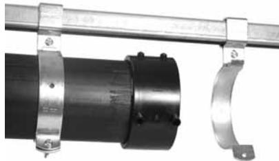
Illustration 55 Pose d'un collier de serrage temporaire à proximité du manchon pour permettre au tube de retrouver sa forme cylindrique
