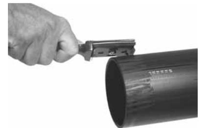
Illustration 51 Raclage de l'extrémité d'un tube à l'aide d'un gratte-tube
