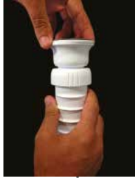
4- Lavabo süzgecinin Hepvo® diyaframının üst rakorlu ağzına saat yönünde çevirerek monte ediniz. Rakoru çekerek contayı sıkıştırınız. d32'lik Hepvo® bağlantısı için kit içerisinde yer alan conta ayrıca kullanılmaktadır.
