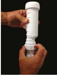
3- Rakor dışını çevirerek diyafram ile birleştiriniz. Körük hortumunu çekerek montajın düzgün olup olmadığını kontrol ediniz.
