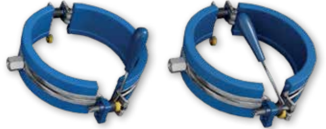
Kayar kelepçeden sabit kelepçeye geçme: Mesafe pulunu çıkarın.
