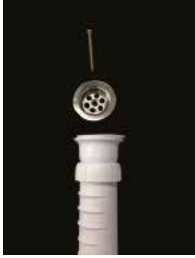
5- Lavabo monte etmek için süzgeç üstü vidasını söküp, metal süzgeç ile plastik taban arasında lavabo kalacak şekilde monte ediniz.
