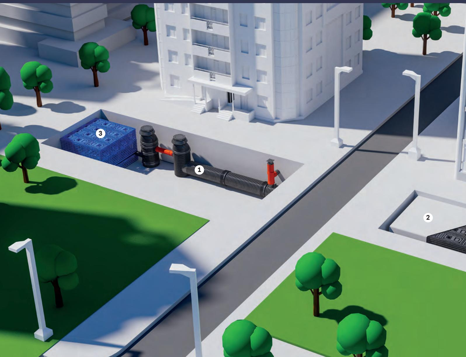
**1.** Il sistema di sedimentazione Wavin Certaro protegge l'infiltrazione da ostruzioni e contaminazioni. Questo sistema separa meccanicamente i sedimenti contenuti nell'acqua piovana, utilizzando il principio della separazione delle densità.
