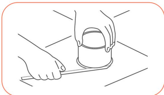
2° - Fixe a vedação na saída do vaso sanitário com a guia para fora. Retire a proteção que envolve o anel de vedação (no caso do 95074).
