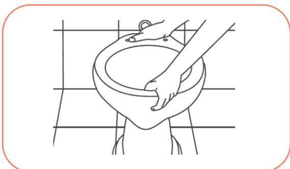
5° - Finalize a instalação do vaso sanitário fixando com parafusos.
