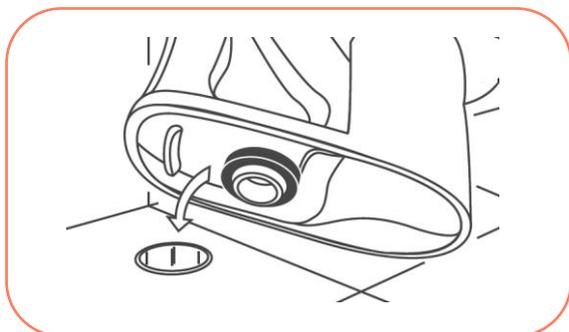
4° - Pressione o vaso sanitário contra o piso para que o anel se acomode e faça a vedação; **ATENÇÃO:** Não esqueça de alinhar o vaso na posição correta de instalação antes de pressionar.
