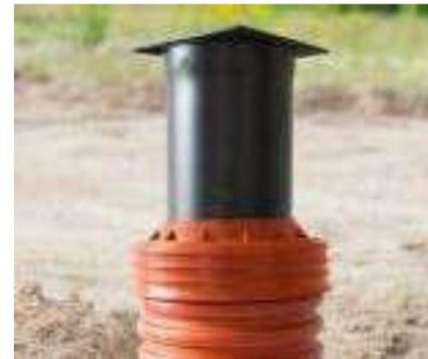
Das angefaste Rohr der Teleskopabdeckung ist ebenfalls zu reinigen und in die Teleskopmanschette zu stecken. Die Mindesteinstecktiefe beträgt 100 mm. Entsprechend den Planungsvorgaben ist die Höhe zu justieren und das Auflager herzustellen. Es kann sowohl ein Betonaufleger aus Ortbeton (C12/15) oder der Kunststoffauflagering eingesetzt werden.
