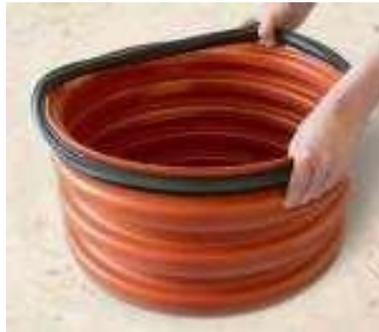
Die Dichtung ist außen in der ersten Welle zu montieren. Hierbei ist auf einen sauberen Sitz zu achten und Verunreinigungen durch z. B. Sand zu vermeiden.
