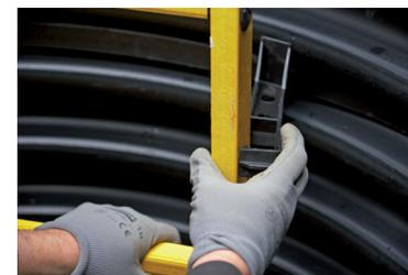
**D -** Clipser les montants dans les supports et repositionner les plaques.
