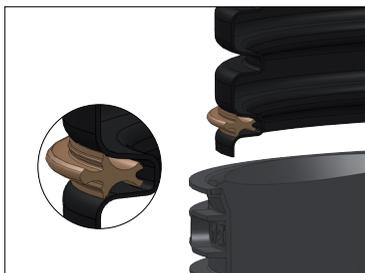
**B -** Appliquer du lubrifiant sur l'emboîture du fond.
