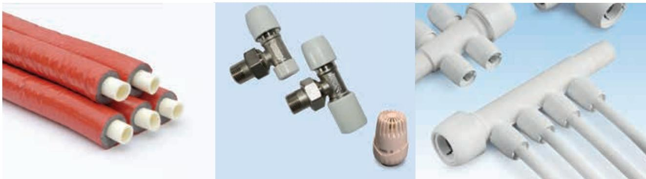
Il sistema **Heptherm** è costituito da tubazioni preisolate in PB, collettori e raccorderia ad innesto rapido. Le tubazioni **Heptherm** sono leggere e maneggevoli, resistenti e di lunga durata per le condizioni di pressione e temperatura impiegate nel riscaldamento, ma non sono idonee al passaggio di acqua potabile. L'isolamento è garantito da una guaina in polietilene (PE) espanso a struttura cellulare chiusa, con pellicola antigraffio di colore rosso. La
