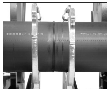
Správně vytvořený svarový spoj na tupo
