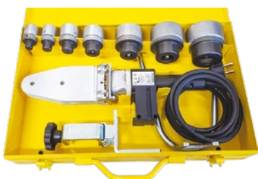
Svařovací komplet R63 s nástavci 16 – 63 mm
