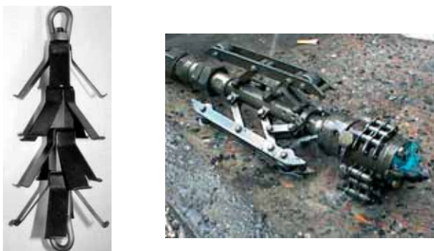
Рис. 7. Устройства для чистки - глубокий скребок (слева) и цепной скребок.
