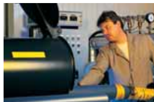
Рис. 45. Моделирование установки трубы Compact Pipe в лаборатории
