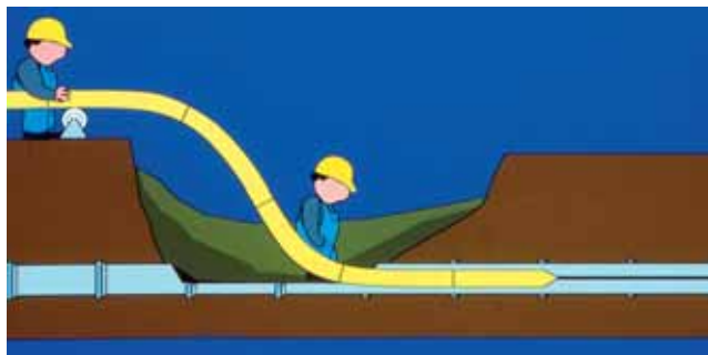
Рис. 9. Протяжка гибкой пластиковой трубы
