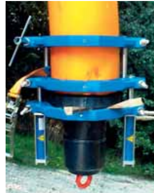
Рис. 20. Металлический наконечник для протягивания (слева) и полиэтиленовая заглушка, приваренная встык к торцу трубы.
