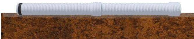
Figura 6.3. Apoyo del tubo sobre la cama de asiento
