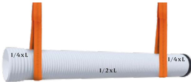
Figura 5.9. Alzaje de la tubería
