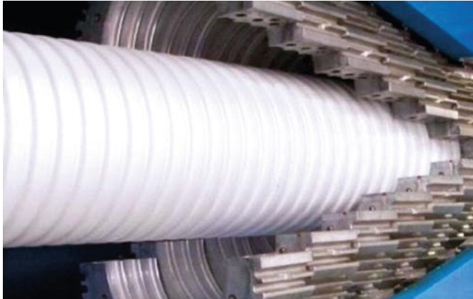
Figura 2.1. Fabricación Tubo NOVAFORT®
