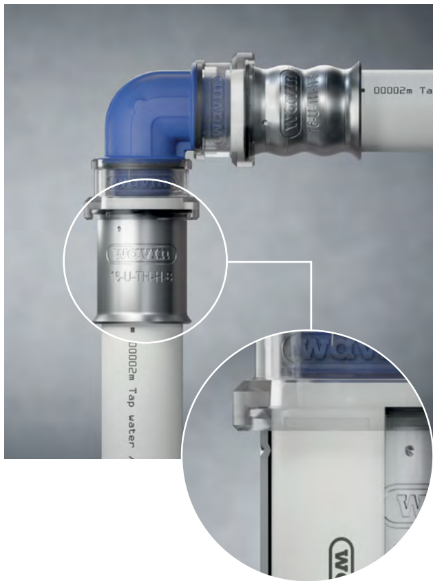
13. ábra: A PIPEGRIP szilárdan a megfelelő helyzetben tartja a csövet, hogy felszabadítsa az egyik kezét a préselő eszköz használatához.
