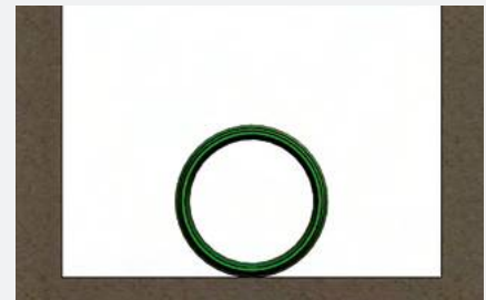
Typ 3: Auflager auf einer vorbereiteten Grabensohle
