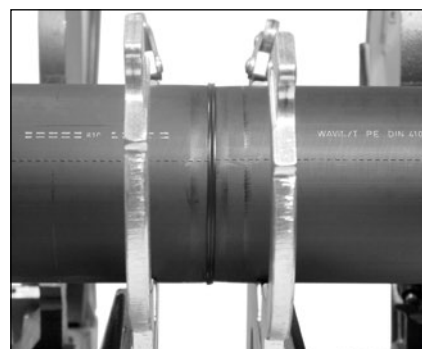
Správně vytvořený svarový spoj na tupu
