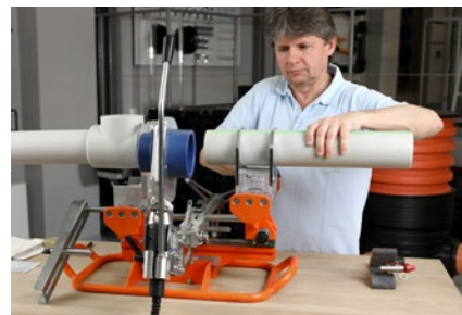
Upnutí do přípravku a vycentrování, poté nahřívání
