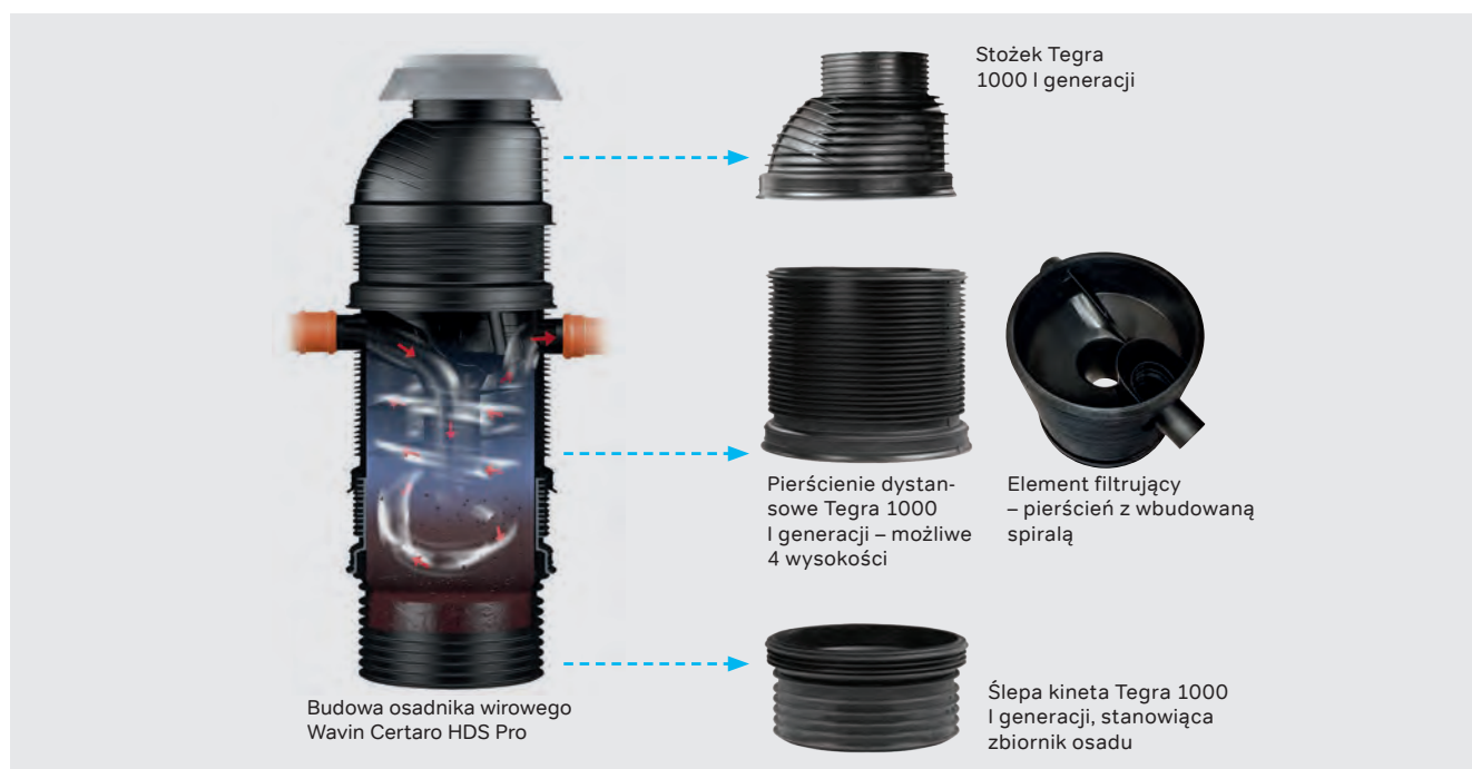
Rys. 16.1.4. Elementy osadnika wirowego Certaro HDS Pro.
