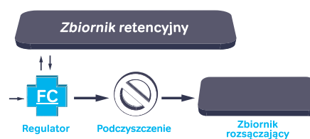
Rys. 10.1.3. Ograniczenie przepływu przed systemem podczyszczania i wypływu do zbiornika rozsączającego.
