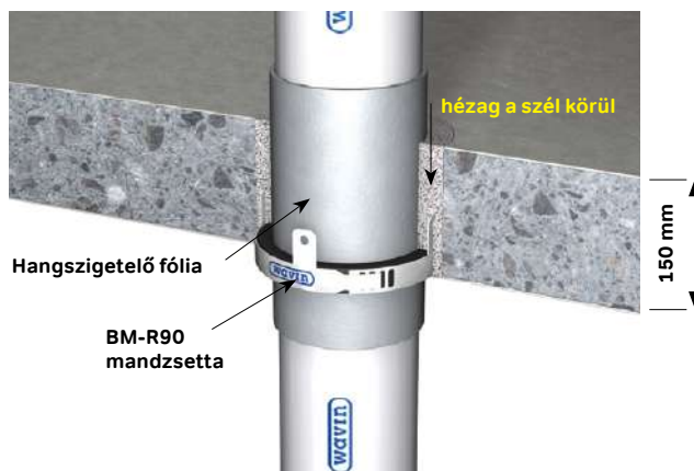
17. ábra: Egyenes beépítés karmantyúval / tokkal / anélkül.
