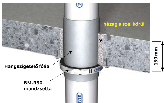
21. ábra: Egyenes beépítés karmantyúval / tokkal / anélkül.
