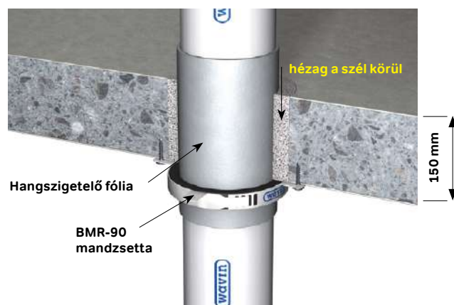
20. ábra: Egyenes beépítés karmantyú / tok nélkül 160 mm-ig.
