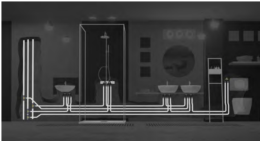
44. ábra: Hurkos szerelés cirkulációs csatlakozással
