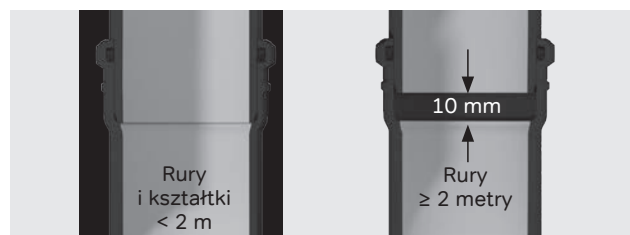
Rys. 55: 10 mm przerwy dla wydłużeń termicznych.
